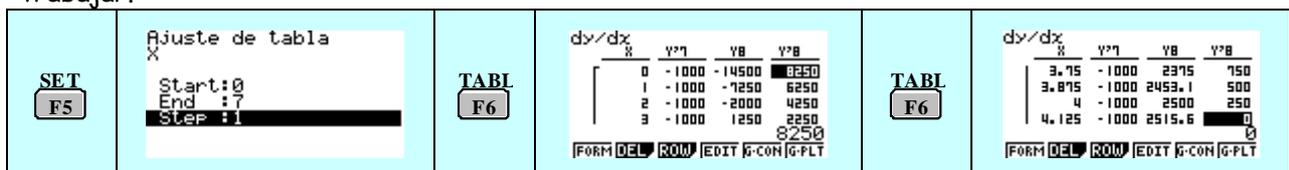
Para x = 4.125 el valor de la derivada de la ecuación del segundo momento flector es nula, lo que indica la presencia de un máximo o un mínimo, que se observa en la gráfica.
